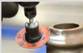
TRUCO Para una mayor flexibilidad al trabajar contornos utilice un plato de tamaño menor que el diámetro de los discos, como por ejemplo un plato de 38 mm para un disco de 50 mm.
