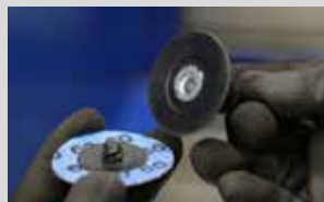
SUJECIÓN TR (Tipo 3 – SL3) Cierre con giro de 2 vueltas y media
