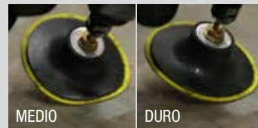
TRUCO Seleccione un plato duro para aplicaciones más agresivas.
